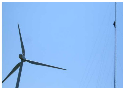
Pose d'un enregistreur à ultrasons sur un mât de mesure pour le suivi des chauves-souris
