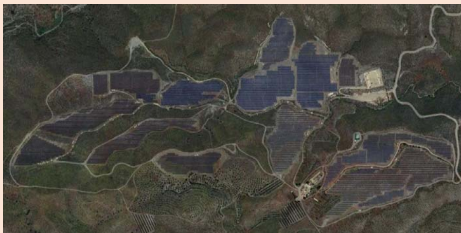
Imatge 5. PSF de grans dimensions amb espais amb vegetació natural entremig (corredor biològics). Lucainena de las Torres (Almería)
