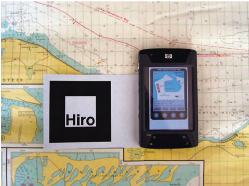
Imatge 3. Un dels primers prototips de mapes amb realitat mixta, que permeten planificar rutes de manera interactiva sobre mapes en paper i, també, superposar-hi informació dinàmica.
