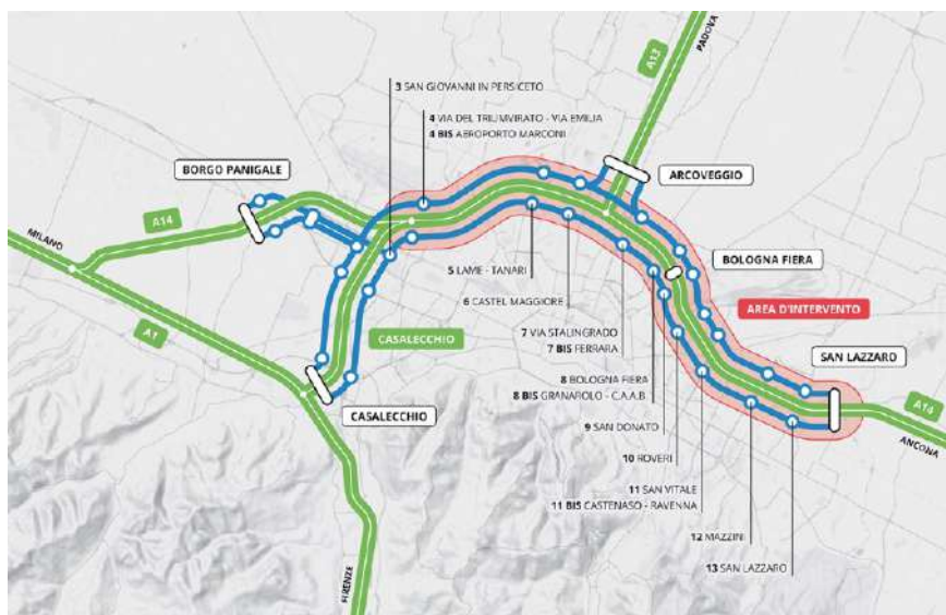
Figura 1. El projecte del Passante di Mezzo afectava un arc de 13 km i implicava l'ampliació de diversos carrils a més d'altres intervencions per mitigar l'impacte urbà i ambiental. Font: Autostrade per l'Italia S.p.a.
