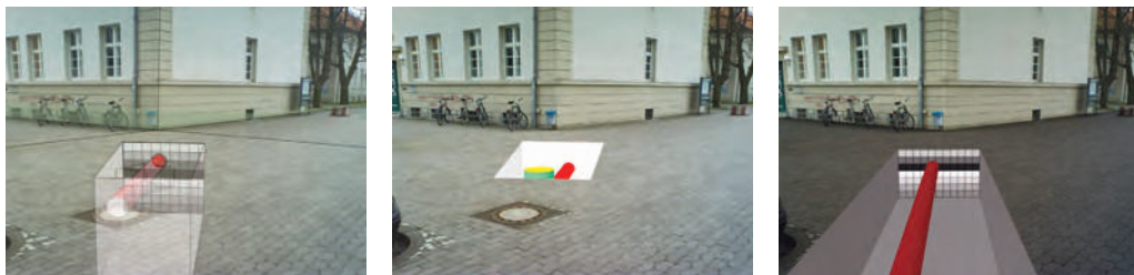
Figura 3. Comparació entre diverses visualitzacions d'infraestructures subterrànies mitjançant l'ús de diferents sistemes de realitat mixta.
