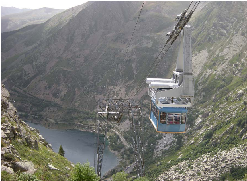
Imatge 3. Telefèric VallFosca, equipament destinat originàriament al transport de mercaderies per la construcció de la central de Sallente i reconvertit en mitjà de transport de passatgers fins a l'estany Gento.
