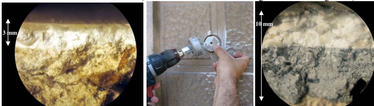
Microfoto d'un arrebossat antic emblancat, mostra d'estuc imitant pedra, i estratigrafia d'un estuc tradicional bicapa.
