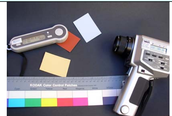
Colorímetres de calibració in situ.
