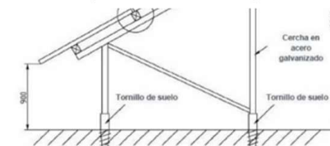
Exemple: Panell solar fixat sense cimentació. Font: Structuralia
