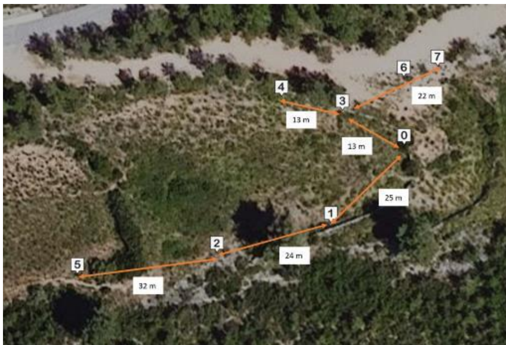
Figura 5 Distribució dels sensors en el terreny
