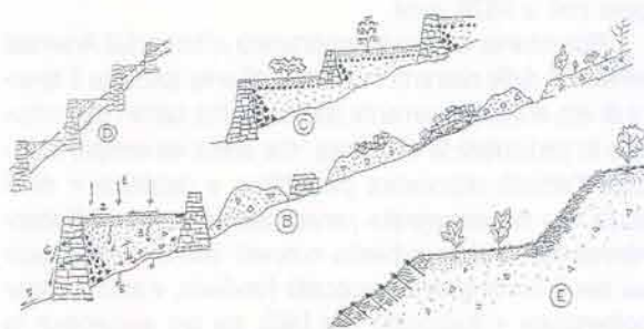
167. Fasi di costruzione delle terrazze. B) rimozione della terra e costruzione delle terrazze:
